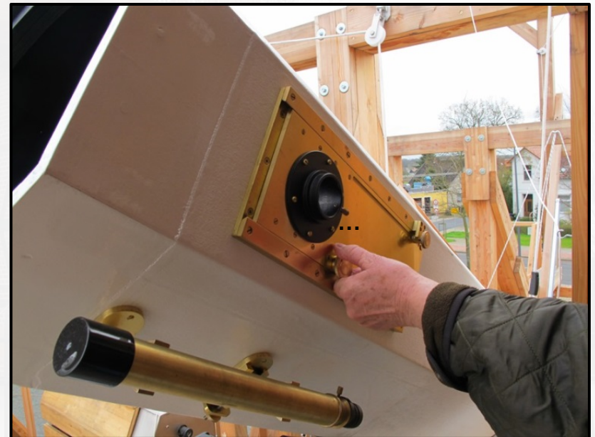
Newton-Fokus & „antikes“ Leitrohr
