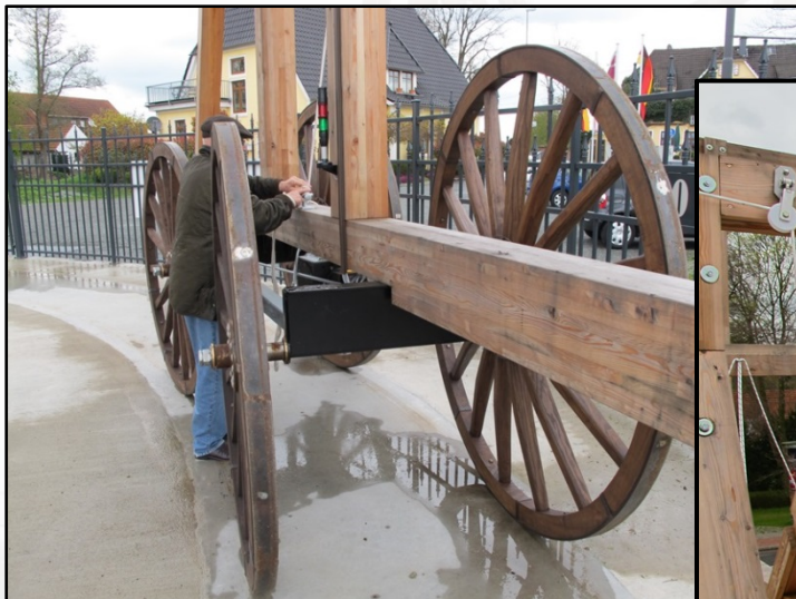
Radkranz des Azimuth-Antriebs
